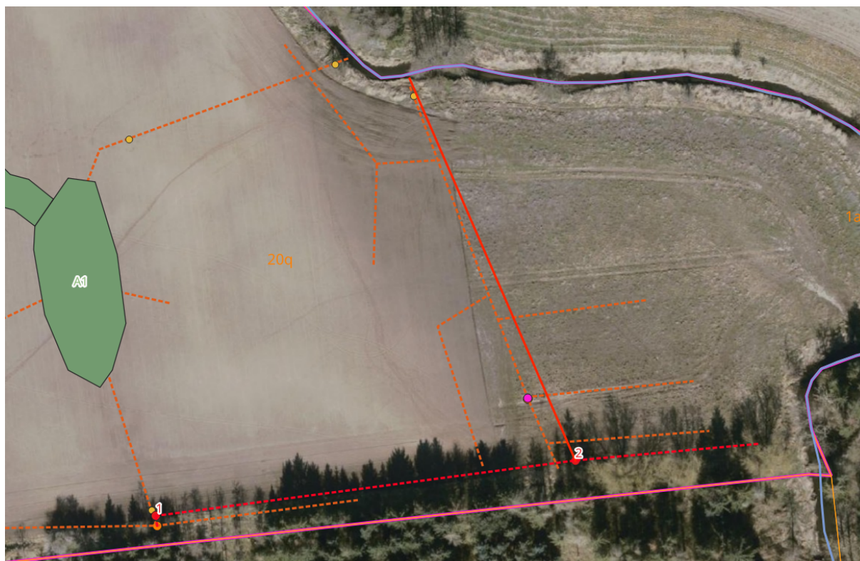
Figur 4-3: Oversigtskort med angivelse af nyt drænsystem. Nye dræn er angivet med stiplede rød streg, nye tætte ledning er angivet med fuldt optrukket rød streg og nye brønd er angivet med rød markering og nr. For øvrig tegnforklaring henvises til Bilag 2.
