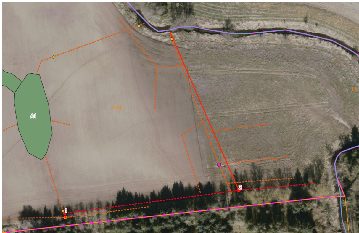
Figur 4-3: Oversigtskort med angivelse af nyt drænsystem. Nye dræn er angivet med stiptet rød streg, nye tætte ledning er angivet med fuldt optrukket rød streg og nye brønd er angivet med rød markering og nr. For øvrig tegnforklaring henvises til Bilag 2.
