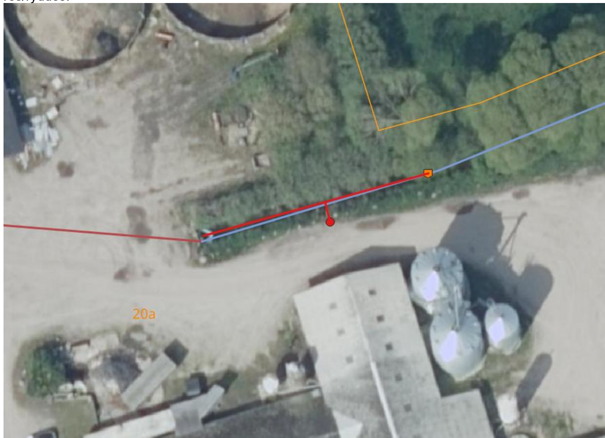
Figur 3: Oversigtskort med angivelse af rørlægning i gårdsplads. Nye rørlægninger er angivet med rød streg, ny brønd er angivet med rød markering og flytning af stensikring er angivet med orange markering. For øvrig tegnforklaring henvises til Bilag 2.
