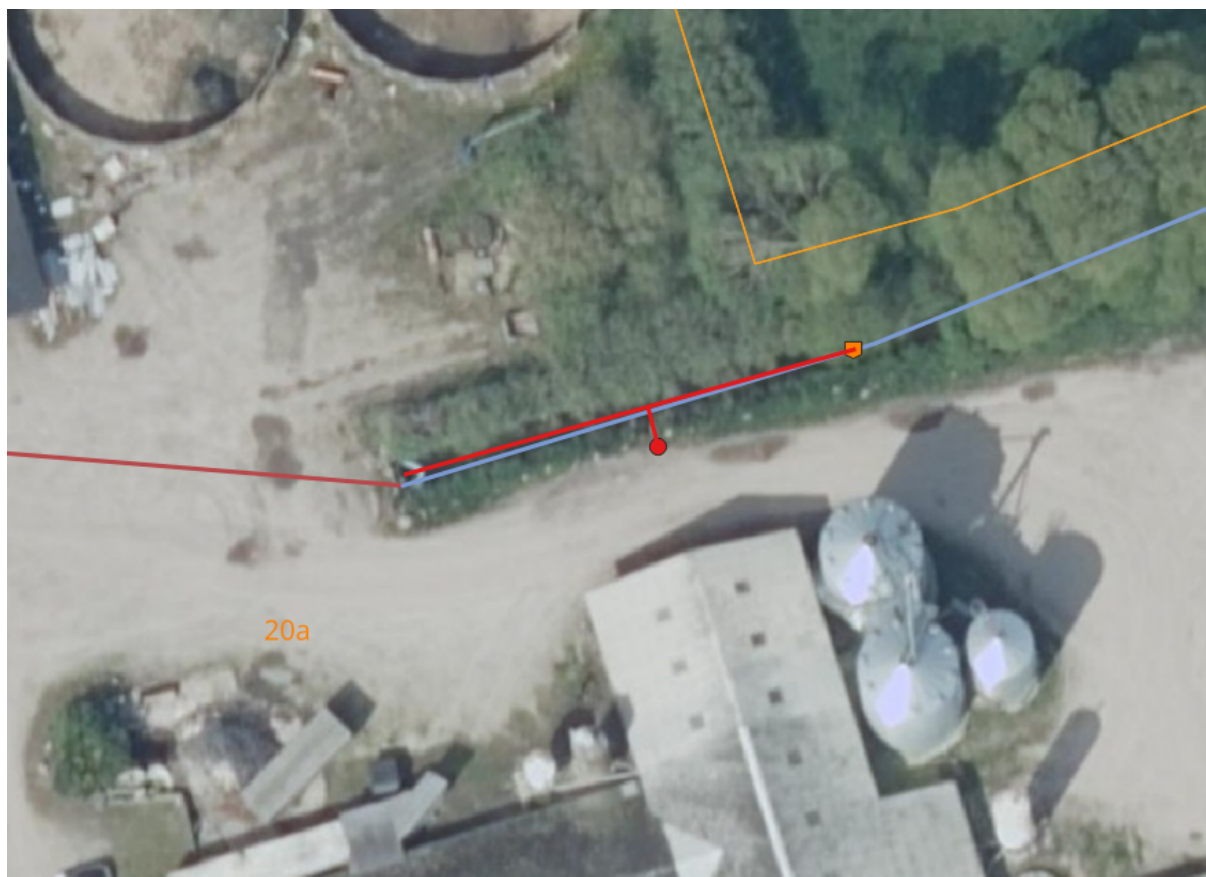
Figur 4-2: Oversigtskort med angivelse af rørlægning i gårdsplads. Nye rørlægningslinjer er angivet med rød streg, ny brønd er angivet med rød markering og flytning af stensikring er angivet med orange markering. For øvrig tegnforklaring henvises til Bilag 2.
