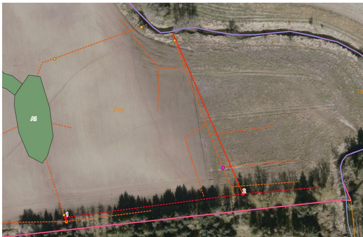
Figur 5: Oversigtskort med angivelse af nyt drænsystem. Nye dræn er angivet med stiplet rød streg, nye tætte ledning er angivet med fuldt optrukket rød streg og nye brønd er angivet med rød markering og nr. 1 og 2. For øvrig tegnforklaring henvises til Bilag 2.
